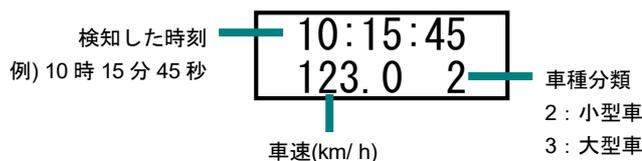
検知したが車速が計測できないような場合(メインセンサでのみ検知された場合など)には、車速部に「---. -」を表示し、車種分類は表示しません。
