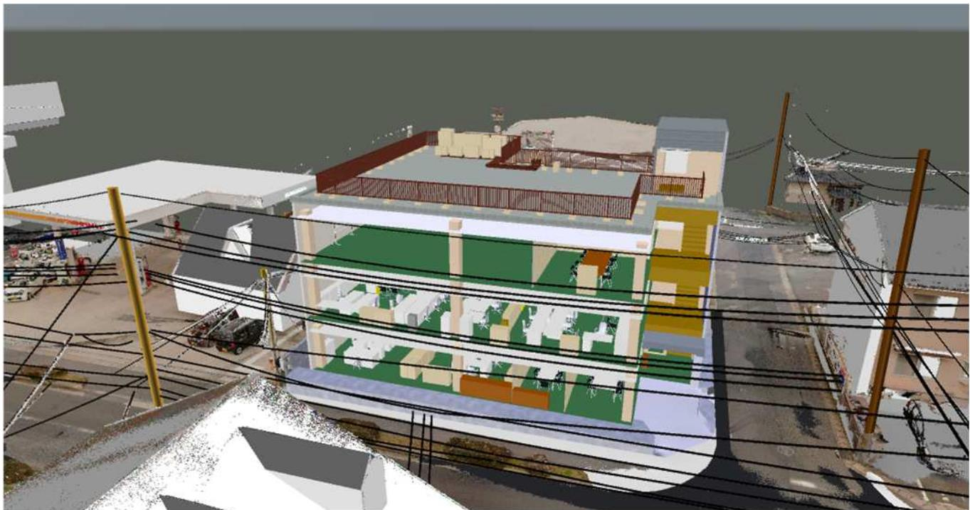
屋内と屋外の点群を一連の計測で取得し、効率的なLOD 4 モデル構築が可能。
